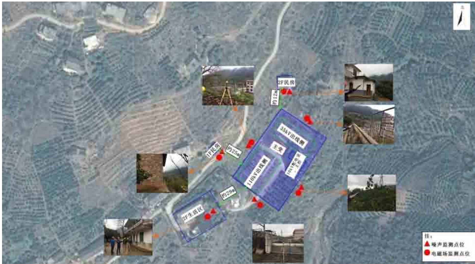
附图 6: 湖南郴州凉亭坳 110kV 变电站平面布置及监测布点图
